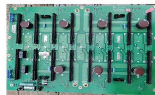
中波发射机主合成器母板背面
