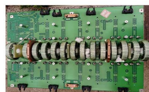
中波发射机主合成器母板正面
